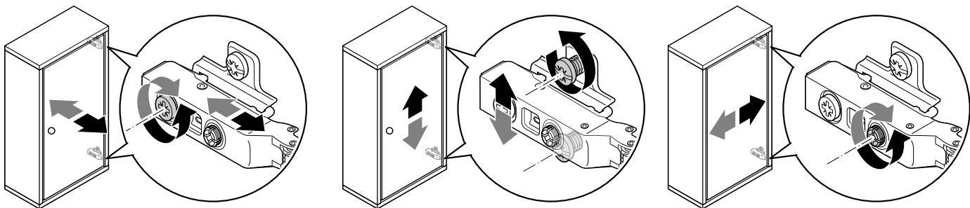
Öffnungsmechanismus einstellen | Réglage du mécanisme d'ouverture | Regolazione del meccanismo di apertura | Adjusting the opening mechanism
